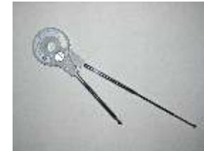
Abb.3 Winkelmessser mit ausziehbaren Mess-Schenkeln
